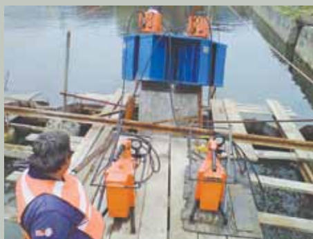
Teste de carga de 500 toneladas exigiu a máxima precisão em cada ação
