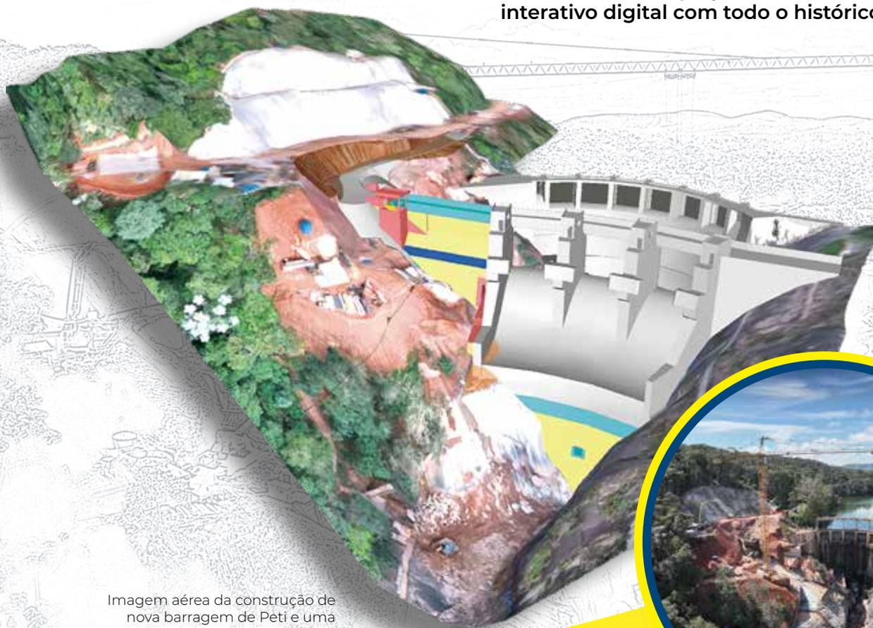
Imagem aérea da construção de nova barragem de Peti e uma representação em 4D BIM
